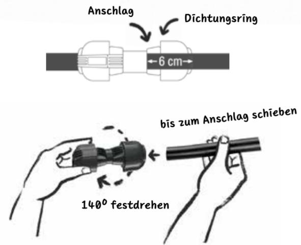
**C** Verbinde jetzt die Elemente. Schiebe die Rohre ca. 6 cm in das Verbindungsteil über den O-Ring. So entsteht eine wasserdichte Verbindung. Vorsicht: Nach ca. 4 cm kommt ein Dichtungsring. Bitte das Rohr an dieser Stelle noch weiter in die Öffnung einführen.
