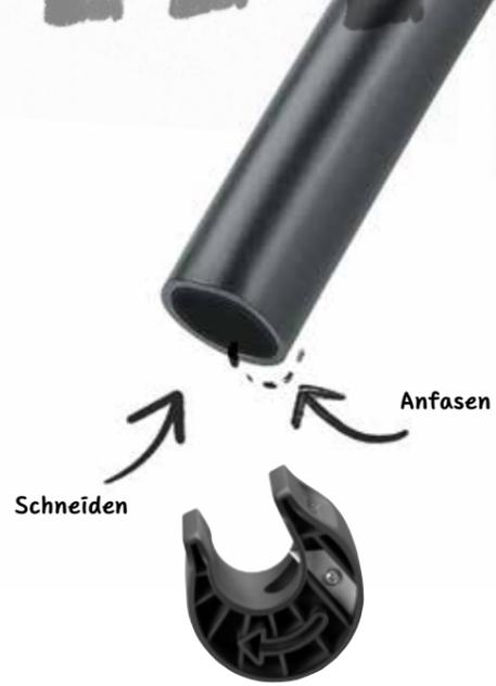
**B** Schneide die Rohre gemäß Plan auf die richtige Länge zu. Achte darauf, dass keine Erde in die Rohrleitung gerät. Falls erforderlich, fase das Rohr an, d.h. entferne unsaubere Schnittkanten. Für gerade Rohr-Schnitte in nur einer Umdrehung, verwende das GARDENA Schneidwerkzeug für Verlegerohr (Art.-Nr. 2727).
