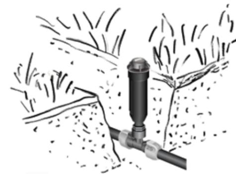
**G** Jetzt platzierst Du die Leitungen mit Anschlussstellen und Regnern im Graben. Alle Regner und Düsen müssen bündig zur Erdoberfläche installiert werden. Der Düsenkopf inklusive Griffmulden sollte sich zur regelmäßigen Reinigung oberhalb der Erdoberfläche befinden.
